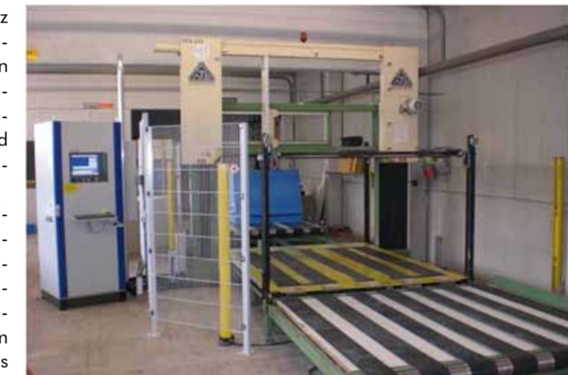
Retrofit Steuerungsumbau bei einer Konturen-schneidemaschine mit CE Konformität / Retrofit controller conversion on a contour cutting machine with CE conformity
