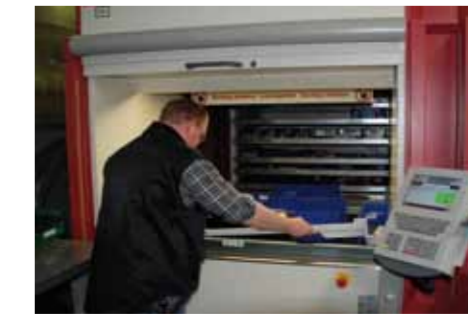
Nachdem die Kommissionsnummer eingegeben wurde, steht innerhalb kürzester Zeit das gewählte Teil bereit. Die Position wird rot angezeigt. Once the commission number has been entered, the selected part is ready within an extremely short time. The position is shown in red.
