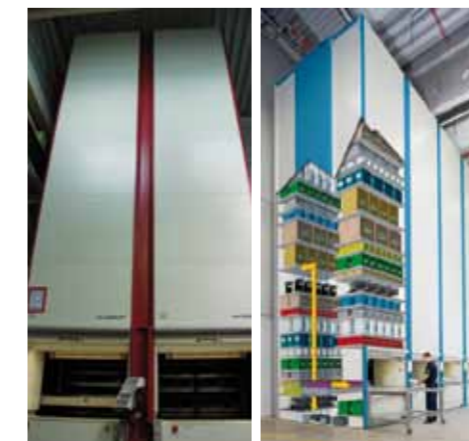
Jedes Tablar (Traglast 500 kg – 50 Tablare pro Liste) ist aufgeteilt in ein virtuelles Raster, das individuell anpassbar ist. Each storage shelf (max. load 500 kg - 50 storage shelves per list) is divided into a virtual matrix that can be individually adapted.
