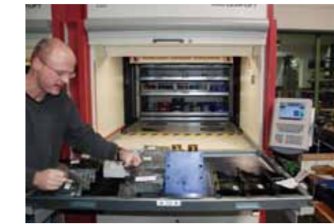
Jedes Tablar (Traglast 500 kg – 50 Tablare pro Liste) ist aufgeteilt in ein virtuelles Raster, das individuell anpassbar ist. Each storage shelf (max. load 500 kg - 50 storage shelves per list) is divided into a virtual matrix that can be individually adapted.
