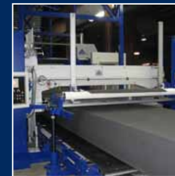
Fig.: Unité de coupe avec dispositif d'enroulement standard BSV-E
