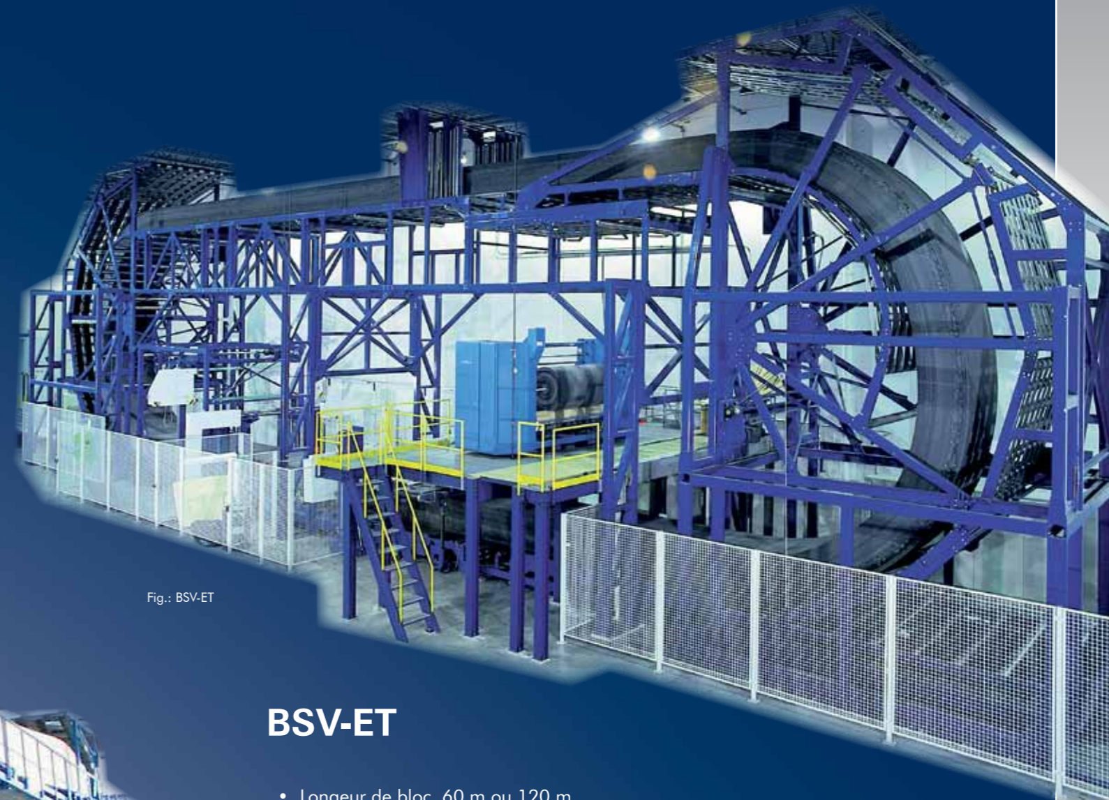
Fig.: Unité de coupe avec dispositif d'enroulement standard BSV-E
