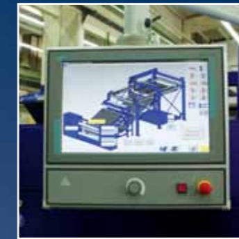
Affichage du dispositif de renversement et du dispositif d'empilage (option)
