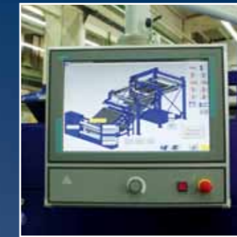
Display con visualización de la estación volteadora y del apilador (opción)
