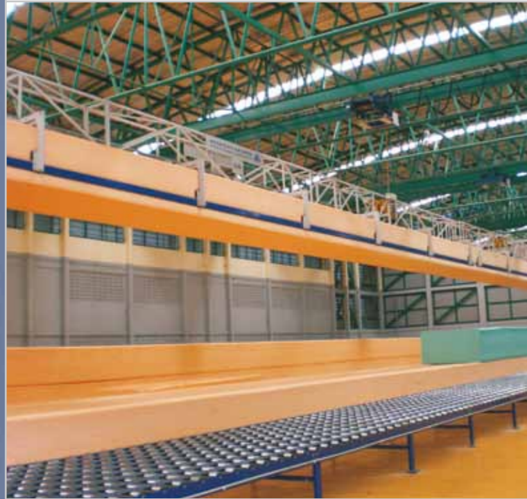
Système de levage de blocs à chariots roulants monorails
