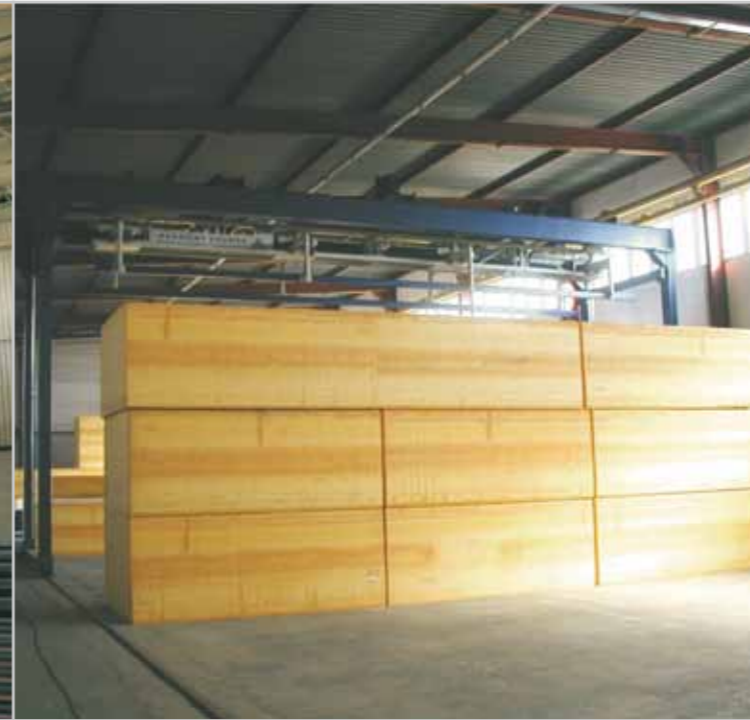
Système de levage de blocs en portique
