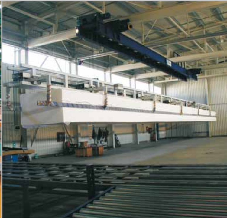
Système de levage de blocs à structure en pont surbaissé
