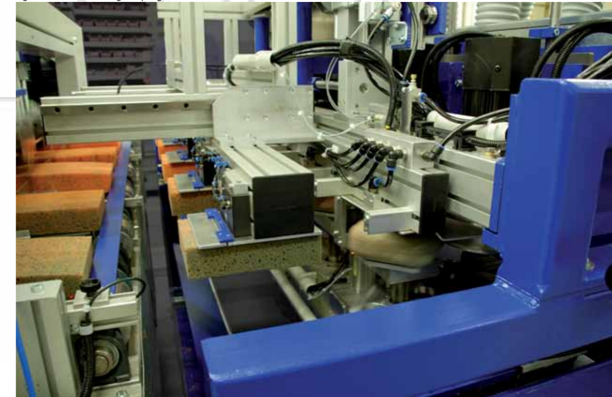
Fig.: Installation de fraisage d'éponges à 5 unités SF V
