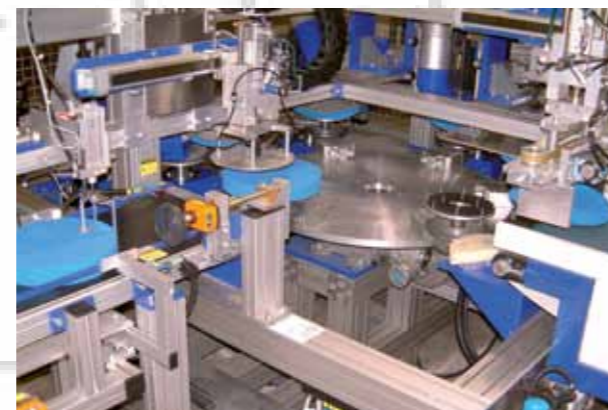
Fig.: Unité de fraisage de disques de polissage SF VI-P
