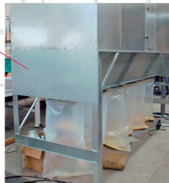
Fig.: Option pour GF 1200. Un puissant dispositif d'aspiration avec une surface de filtrage globale de 32 m 2 élimine la poussière de fraisage de la zone d'usinage.
