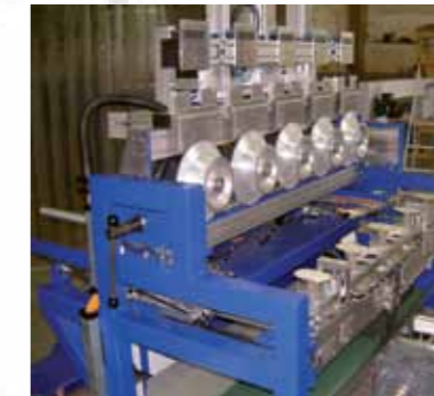
Fig.: Unité avec 5 têtes de fraisage SF V
