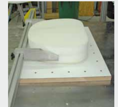
Fig. : Fixation du matériau avec panneau supplémentaire de support du matériau
