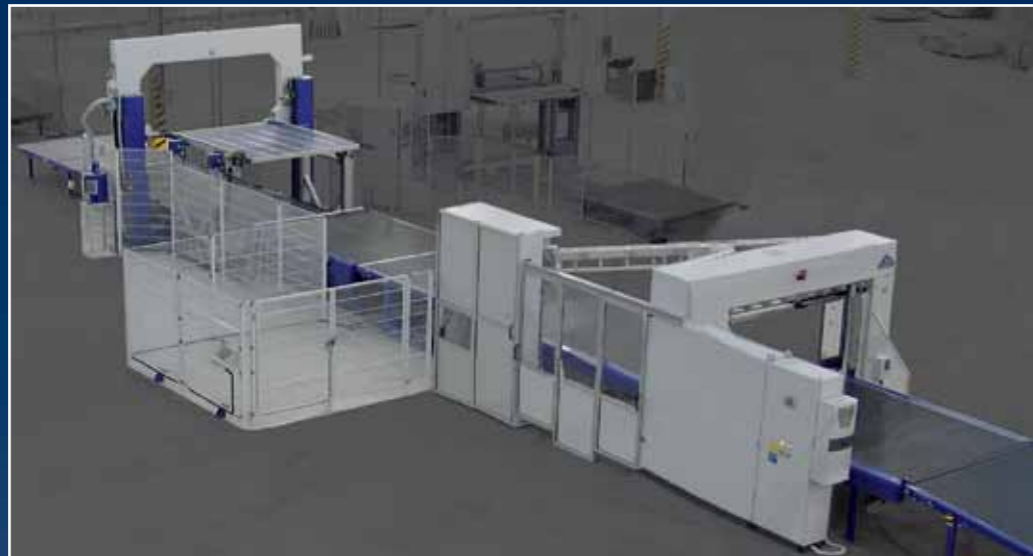
Fig.: Ligne de coupe: Machine de coupe de contours OFS-VS avec machine de coupe horizontale BSL 214
