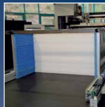
Fig.: Appui latéral mobile
